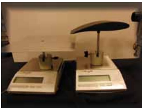
Fig. 5. Experimento de la “doble balanza” para medir el down-wash , realizado con un perfil alar en lugar del semicilindro. El aire desviado por esta superficie lo recoge la segunda balanza. La sustentación generada sobre el perfil (peso negativo en la primera balanza) corresponde cualitativamente al peso del aire desviado hacia abajo y medido por la segunda balanza.
