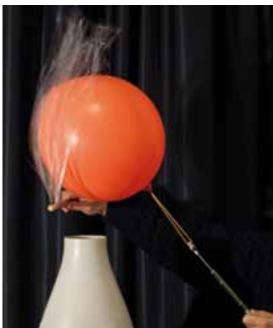
Fig. 2. Con ayuda de un globo, un dinamómetro y un elástico es posible medir la fuerza que el flujo de aire genera en su interacción con el globo.
