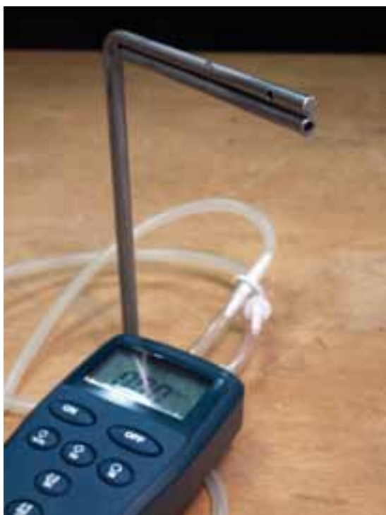
Fig. 9. Sensor de presión total (tubo con el orificio central) y estática (tubo con el orificio lateral), conectado a un manómetro diferencial, que da directamente la diferencia entre las dos. En ausencia de viento (en la imagen) el sensor registra un valor nulo: P_T = P_S , correspondiente a la presión atmosférica.
