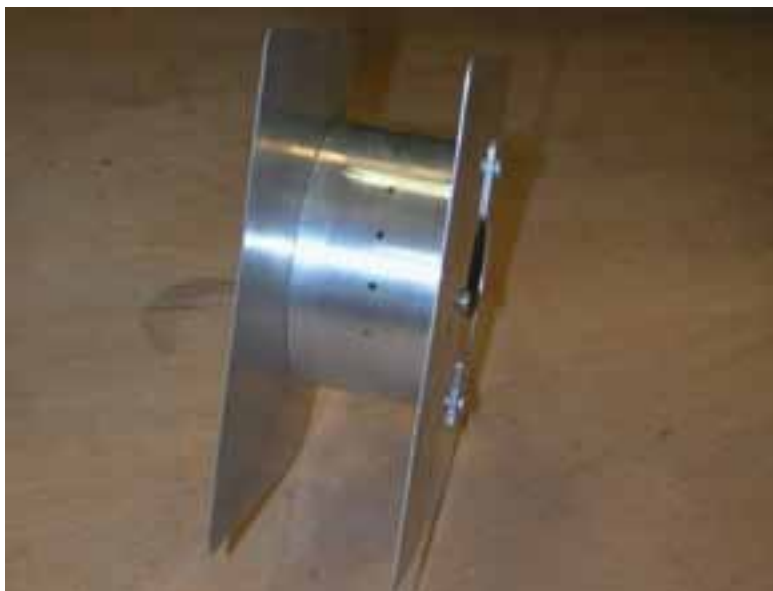
Fig. 4. Un conjunto de siete orificios practicados en un semicilindro permite medir el campo de presión sobre su superficie cuando es sometido a un flujo de aire. Las “aletas” laterales sirven sólo para canalizar mejor el flujo de aire.
