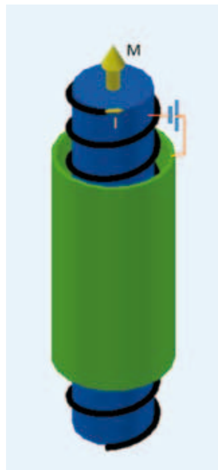
Fig. 6. Esquema de un motor electromagnético.
