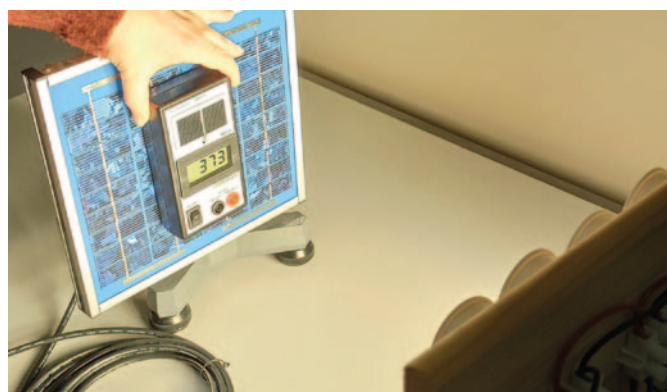
Fig. 2. Medida de irradiancia G . No todos los piranómetros dan la lectura directamente en \text{W/m}^2 , pero este ejemplar sí lo hace. La parte inferior derecha de la imagen muestra una porción del simulador LED.
