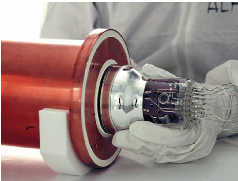
Fig. 10. Detalle de uno de los módulos de ANAIS en el proceso de acoplo al fotomultiplicador de alta eficiencia cuántica en la sala limpia del Laboratorio Subterráneo de Canfranc.
