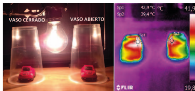
Figura 9. Demostración del efecto invernadero: el coche del interior del vaso cerrado alcanza mayor temperatura que el coche situado dentro del vaso abierto.
