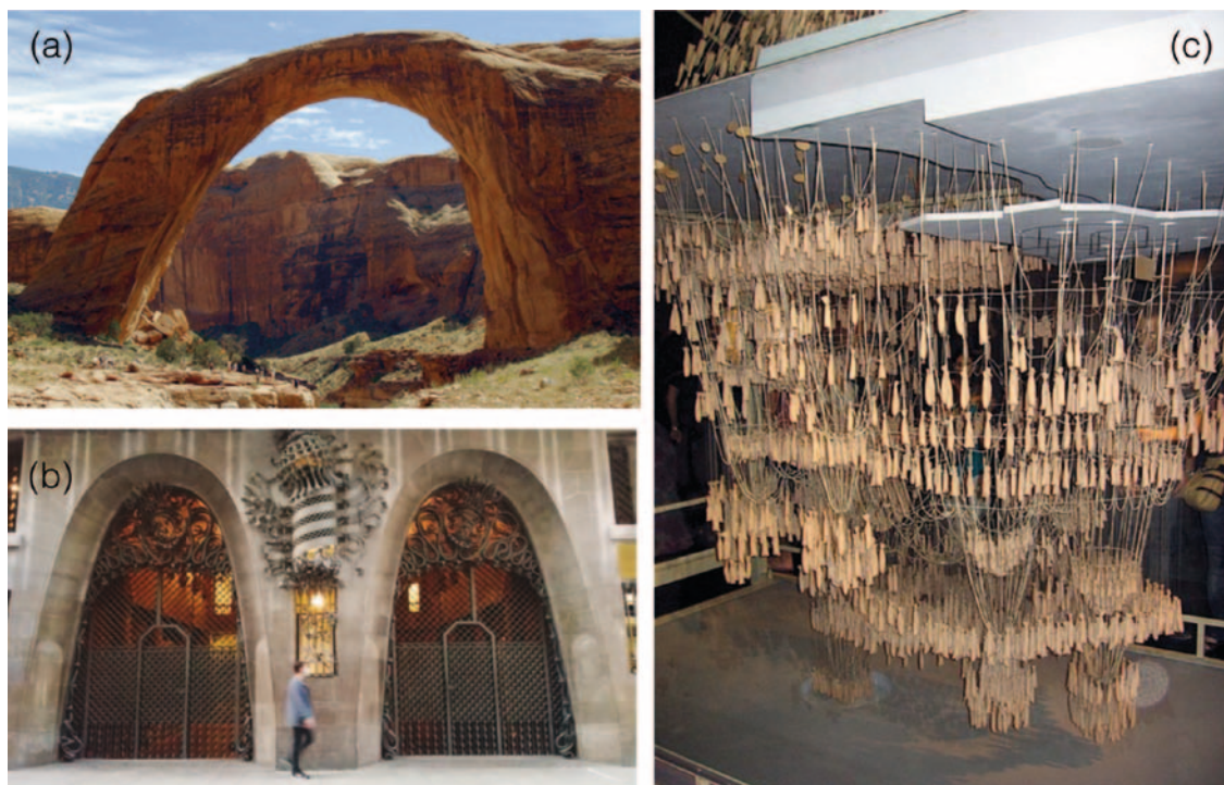
Fig. 1. (a) Arco natural en el parque nacional del Glen Canyon, Utah. (b) Arcos de entrada al Palau Güell, Barcelona. (c) Reconstrucción de la maqueta funicular utilizada por Gaudí para diseñar la cripta de la colonia Güell, expuesta en el museo de la Sagrada Familia, Barcelona [1].
