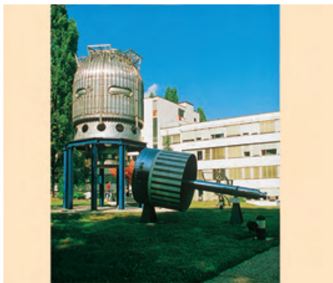
Cámara de burbujas desmontada en los jardines del CERN. A la derecha, el émbolo (CERN photo)
