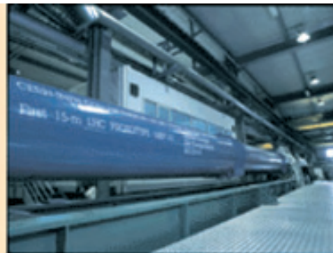
Cavidad (izquierda) e imán dipolar de 15 metros, superconductores, prototipos de los que se utilizarán en LHC (que requerirá 1232 imanes del tipo mostrado). (CERN photo)
