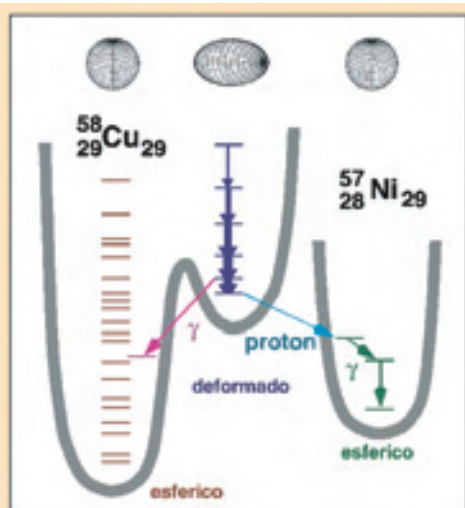
Figura 6. Ilustración de la desintegración de protones prontos desde el segundo mínimo de ^{58}\text{Cu}_{29} en los estados esféricos del núcleo hijo ^{57}\text{Ni} .
