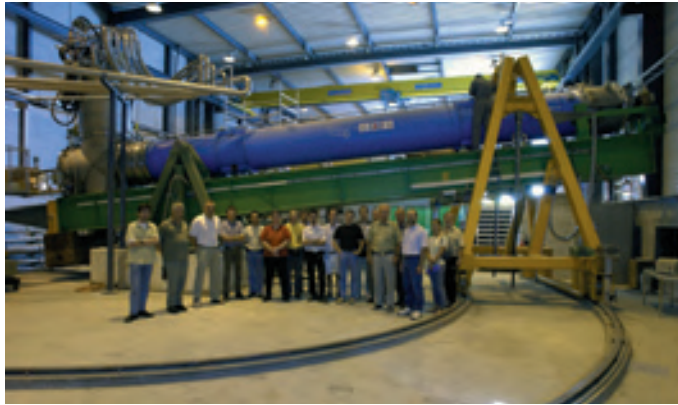
Miembros de la colaboración CAST posan ante el experimento poco antes de la primera toma de datos preliminar (agosto 2002). El imán sobre su plataforma ocupa detrás todo el espacio de la fotografía, a la izquierda se aprecia parte de la instalación criogénica conectada al imán y a la derecha uno de los detectores, colocado en el extremo del imán.
