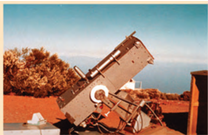
Figura 2. Fotopolarímetro de la Universidad de Burdeos (Francia), el primer telescopio profesional instalado en el Observatorio del Teide (Tenerife) y diseñado para hacer fotopolarimetría de la luz zodiacal.
