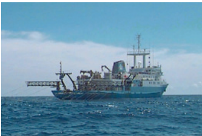
Figura 1. Adquisición de datos de un perfil sísmico marino a partir del buque oceanográfico americano M. Ewing . En la figura se observan las grúas laterales que arrastran la red de cañones de aire comprimido, mientras en la parte central de popa se despliega el "streamer" o cable de varios km que contiene cada 25 m un hidrófono que registra los disparos.
