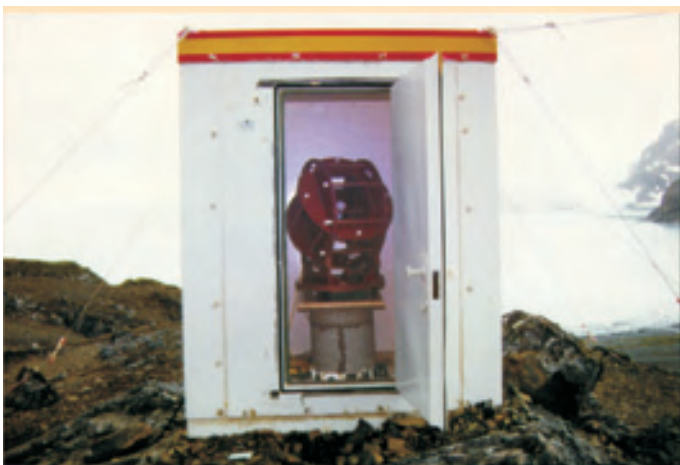
Figura 4. Sistema de bobinas de Helmholtz y magnetómetro de precesión de protones que configuran el magnetómetro vector del Observatorio Geomagnético de la Isla Livingston, Islas Shetland del Sur, Antártida.
