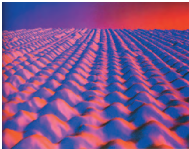
Imagen STM de la superficie de un cristal de Si (las filas de átomos están separadas 0,77 nanómetros)
